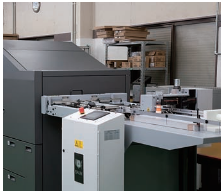
最長660mmの長尺シートに対応したロングシート フィーダー
